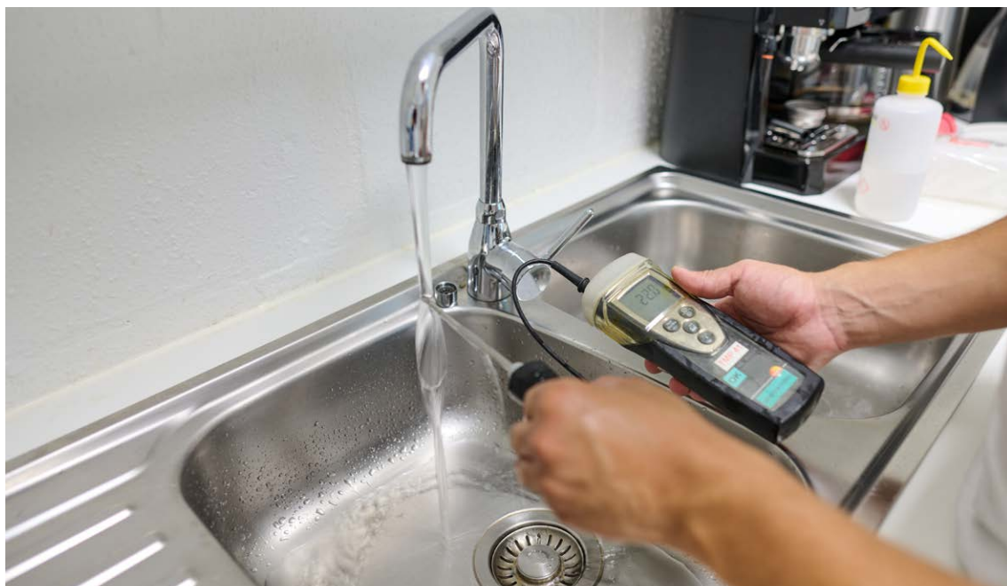
Prélèvement eau de distribution : mesure de chlore libre résiduel
